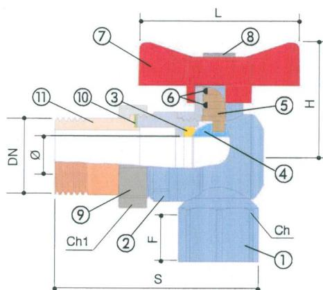
Kulové kohouty art. 75 E vyhovují směrnici CE 97/23/CE a všechny kusy jsou kontrolovány na 100% hydraulickou těsnost.
